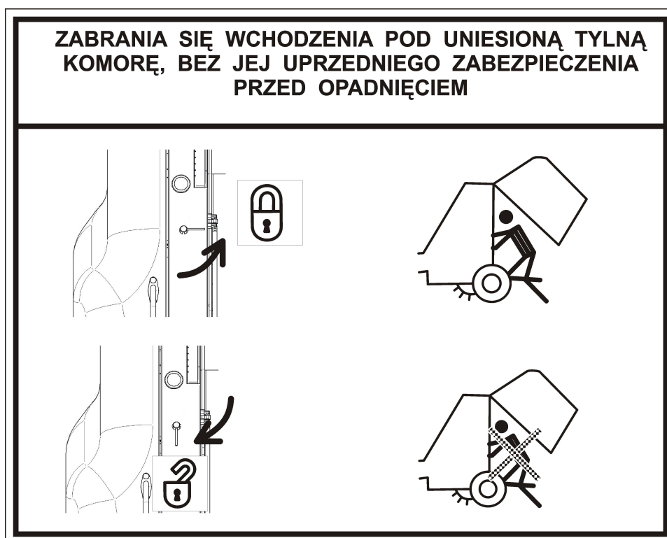
Rys. 27 Zabezpieczanie komory tylnej
